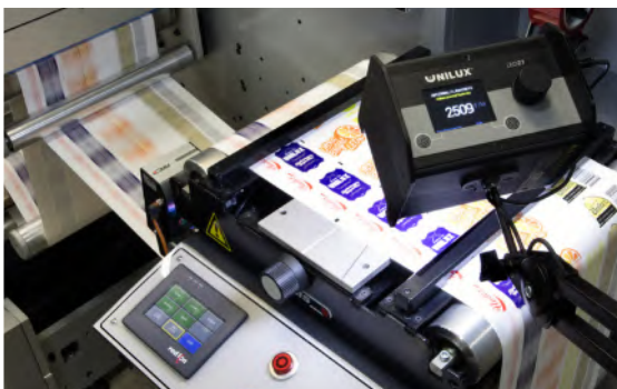
Zwei Anbaumöglichkeiten: An der Ober- oder Unterseite des Stroboskopes
