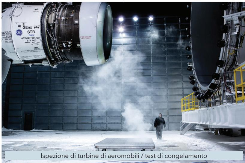
Ispezione di turbine di aeromobili / test di congelamento
