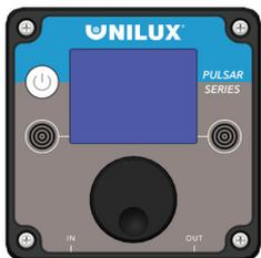
Diversi stroboscopi PULSAR possono essere collegati in rete con o senza controllo remoto per consentire tecniche di ispezione speciali (come l'ispezione a luce incrociata) o l'illuminazione di aree più ampie.
